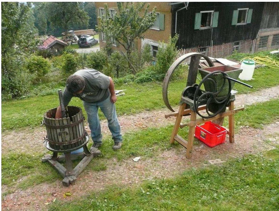
Im Bild rechts der Häcksler/Schredderer, in dem Äpfel/Birnen zerkleinert werden, links die Saftpresse. Beim Häcksler befindet sich auf der Vorderseite das eiserne Schwungrad, auf der Rückseite die Konstruktion für den Riemenantrieb..
