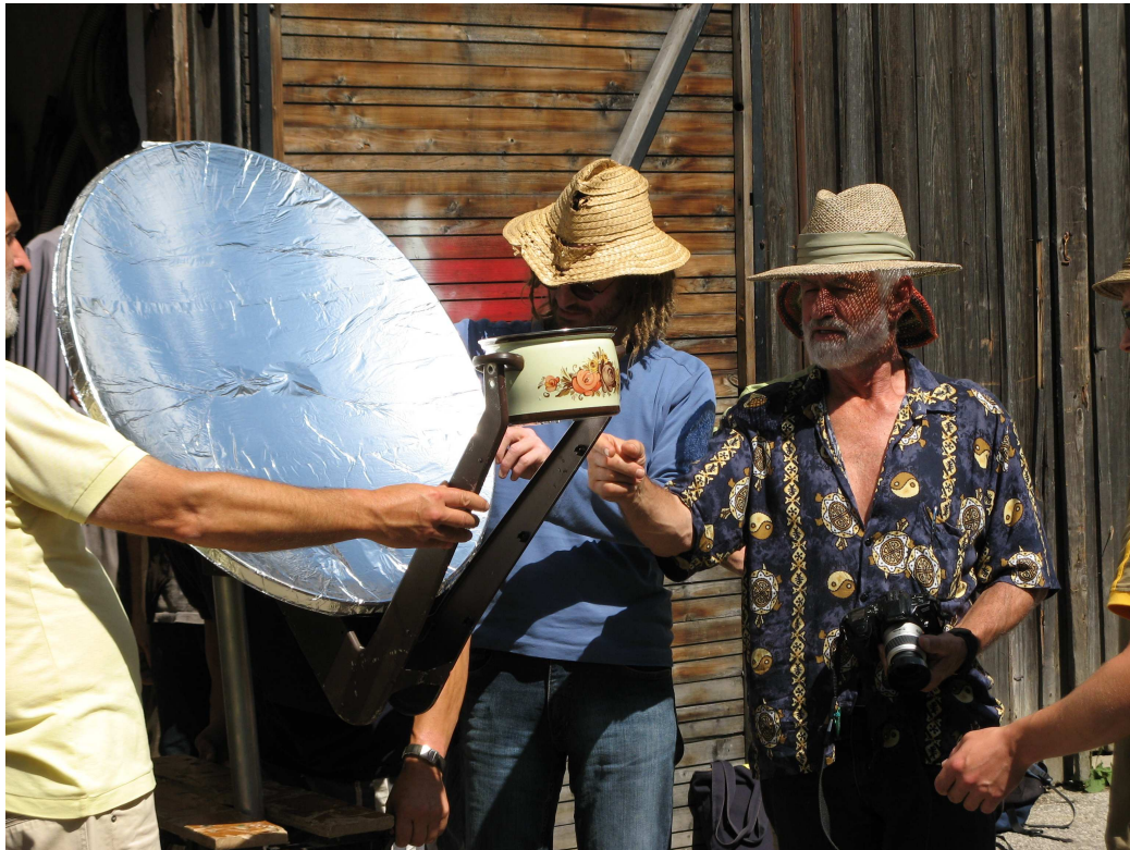
Solarkocherherstellung mit Erwin Zacht während einem Diplomkurs 2007 mit dem 2008 verstorbenen Joe Polaischer (im Bild rechts). Hier wird eine Satellitenschüssel mit Alufolie beklebt. Der Arm wurde gespreizt bis der Topf einhängen konnte (Topf gehört noch schwarz angestrichen)
