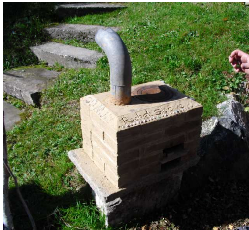
Oben: Bau mit einigen Kindern Bild links: Frisch verputzt im Workshop Lehm/Lehmofen im Juli 2009 Bild rechts: Modifiziertes Grundmodell eines Teilnehmers des Julikurses mit Rohr und Herdplatte zum rausnehmen
